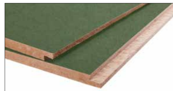
ВЕТРОЗАЩИТНАЯ ПЛИТА 25 мм С ФРЕЗЕРОВАННЫМИ, 2 сторонними краями “полушпунт” 800 x 2400
